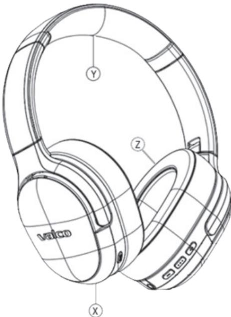
Em relação à instalação do fone supra-auricular VMK25 na cabeça, há três partes que você precisa conhecer e entender. A letra Y indica a parte superior que é chamada de "arco da cabeça". A letra X indica o auscultador que contém as espumas almofadadas. A letra Z indica as espumas almofadadas macias inseridas ao redor das suas orelhas.
