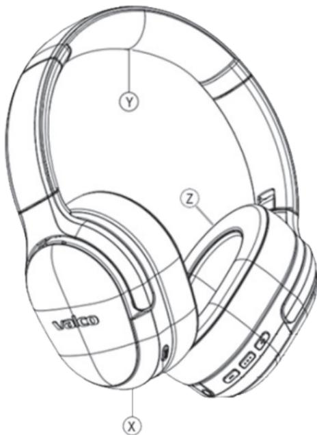
Når det gjelder sammensetningen av VMK25-hodetelefonene, er det tre deler du trenger å kjenne til og forstå. Bokstaven Y indikerer den øverste delen som kalles «hodebøylen». Bokstaven X indikerer øreklokkene som holder fast øreputene. Bokstaven Z indikerer de myke øreputene som er ment å dekke over ørene dine.
