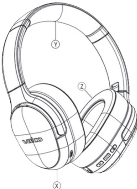
Bei der Kopfmontage des VMK25-Kopfhörers musst du drei Teile kennen und verstehen. Der Buchstabe Y bezeichnet den oberen Teil, der „Kopfbügel“ genannt wird. Der Buchstabe X bezeichnet die Hörmuschel, in der sich die Ohrpolster befinden. Der Buchstabe Z steht für die weichen Ohrpolster, die um deine Ohren herum eingesetzt werden.
