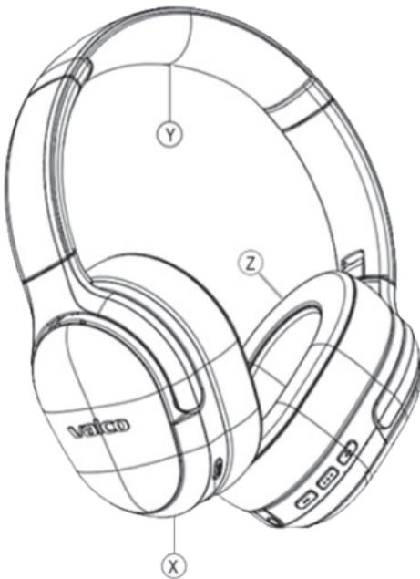
Pokud jde o instalaci sluchátek VMK25 na hlavu, existují tři části, které potřebujete znát a pochopit. Písmeno Y označuje horní část, která se nazývá „náhlavní obroučka“. Písmeno X označuje mušli, ve které jsou umístěny náušníky. Písmeno Z označuje mékké náušníky, které se nasazují kolem uší.
